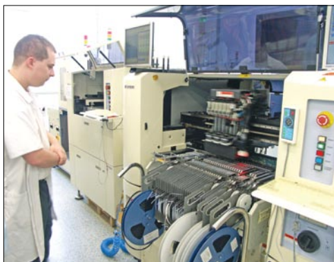
Produkcja – linie montażu powierzchniowego, stanowisko do testów optycznych
